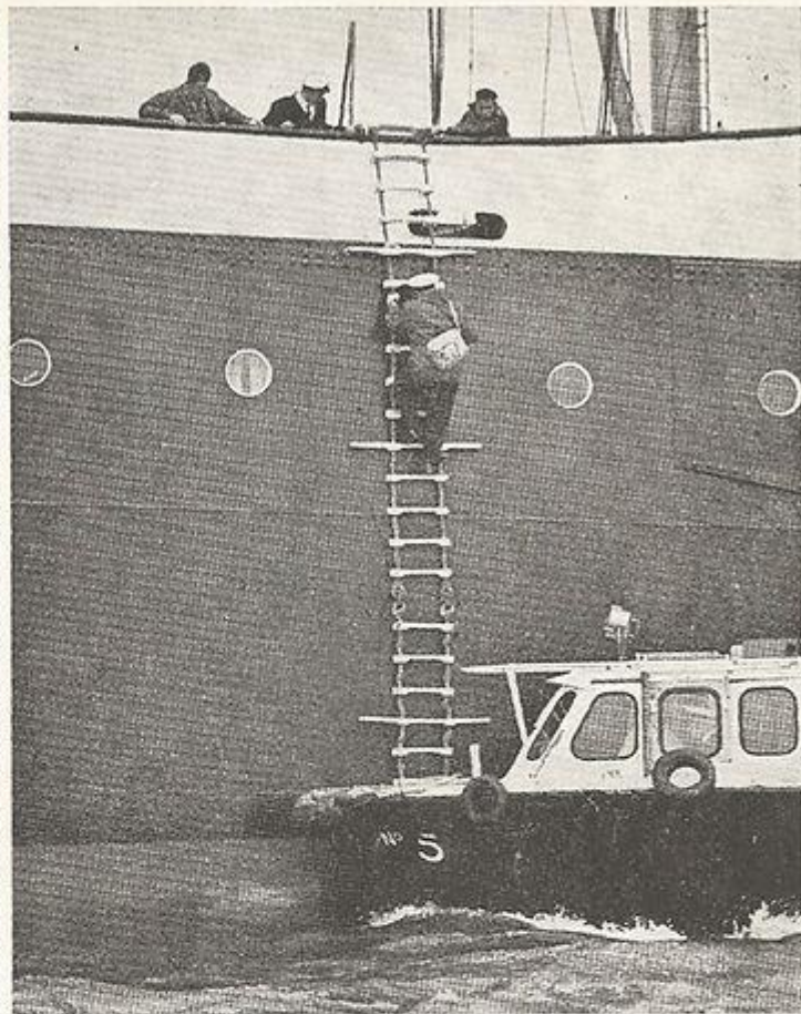
ממבט ראשון נראה כי הסולם הזה בסדר, אבל התכוננו וא במרחק בין השלביים במקום בו מחוברים הסולמות; בממדי הפזקות והסביבוליים המונעים החזקה נאותה בין שני השלבים; במעקה על סולם החוקים ולא על הלבוזת.
