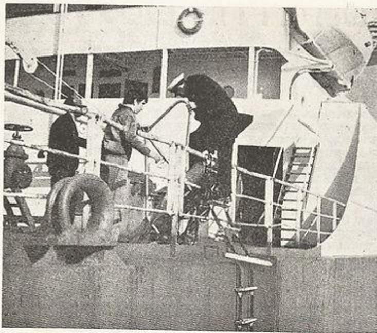
יותר לוליינות דרושה כשקיים מעקה אחד בלבד, וסולם חוקקים זה אינו בטוח כראוי.
