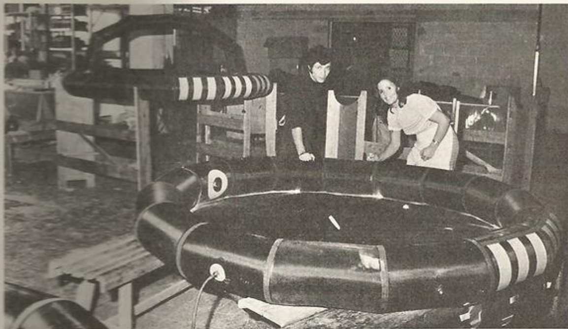
שלבי הייצור הראשונים. מימין, "גלגל ההצלה" הגדול המשמש כשלד לרפסודה. משמאל: שלב שני התמיסה אמריקני.
